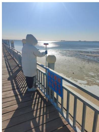
华测 K50GNSS 仪器 现场测量
